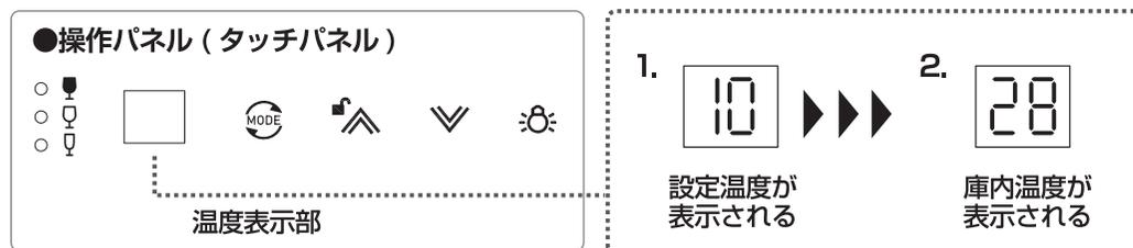
※本機器を初めて使用するときは、内部温度が適切に調整されるまで約24時間かかります。
